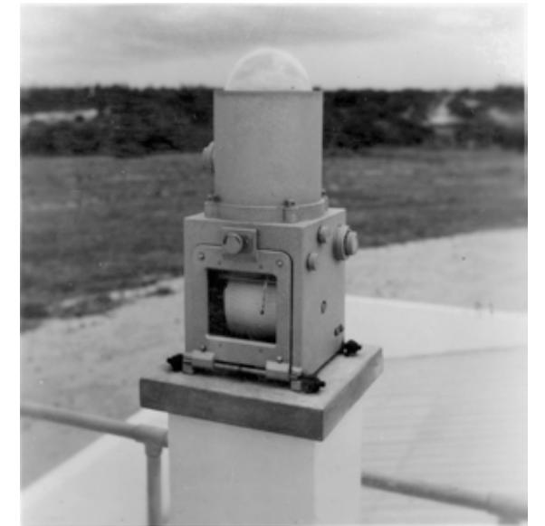
Actinógrafo da Estação Meteorológica da Escola de Agronomia, instrumento utilizado para medir a radiação solar [entre 1961 e 1963] Fonte: Memorial da UFC
